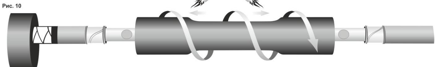
**Рис.11** Обмотать тело муфты медной экранирующей сеткой с 30% перекрытием, с заходом по **15мм** на оболочки кабелей, см. рис.
